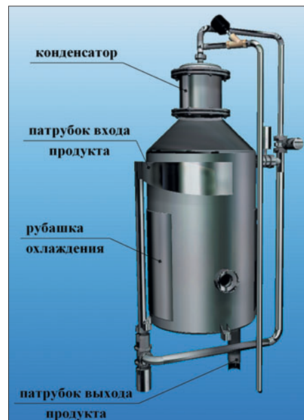
Рис. 4. Корпус деаэратора в сборе
